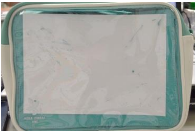
←キャラクターシートの印刷の一部が、ポーチの透明ビニールシート面に色移りしている状況
